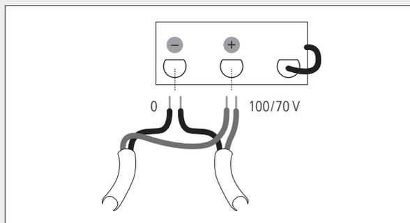
I collegamenti con la linea audio si realizzano tramite il morsetto ceramico presente all'interno del diffusore acustico (occorre rimuovere il fondello posteriore svitando le 3 viti).
