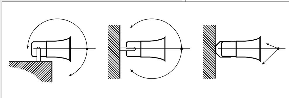
Orientare il diffusore acustico verso l'area d'ascolto e bloccare la posizione serrando i due bulloni presenti alle estremità della staffa di fissaggio.
